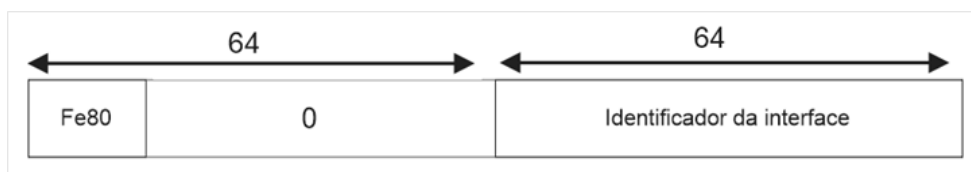
Figura 2.23 – Endereço link Local (RFC 3513).
