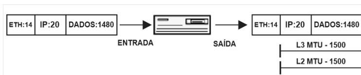
Figura 7.20 – MTU roteamento simples.
