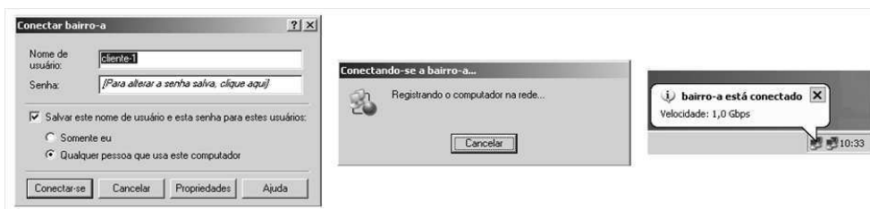
Figura 7.78 – Passo a passo: Tentativa, registro e confirmação de acesso ao servidor PPPoE em RB2-Gateway.
