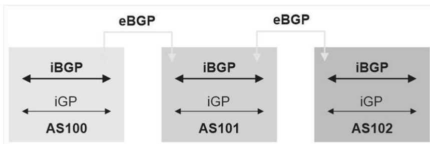
Figura 3.50 – Modelo de representação de como funciona o BGP dentro e entre ASs.
