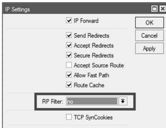
Figura 4.63 – Desativando a verificação RP Filter do Kernel do sistema.
