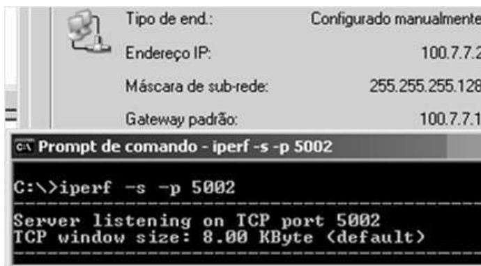
Figura 6.58 – Iperf no modo servidor porta 5002.
